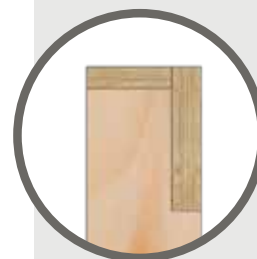
Nacięty słupek ścienny z ciągłym nadprożem i oczepek
